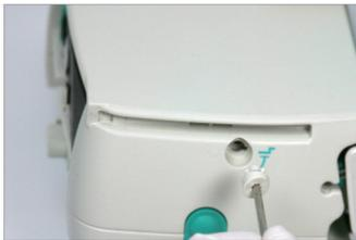
Retire la tapa del sistema de apertura de emergencia.
