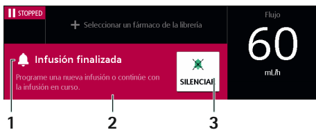
Figura 2: Ventana de alarma 1. Nombre de la alarma, 2. Indicaciones de resolución de la alarma, 3. Pausar la señal acústica de alarma / minimizar la ventana de alarma.
